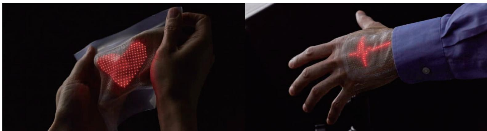
スキンディスプレイは、伸縮自在で皮膚にも貼付け可能な薄型ディスプレイです。厚みはわずか1mmで、16×24個のマイクロLEDが埋め込まれています。繰り返し45%伸縮させても、電氣的・機械的特性が損なわれることなく使用できます。
